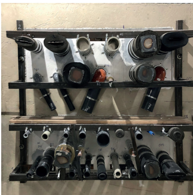
wykonanie otworów w bloczkach SAFETY BLOCK dla przejścia instalacji
