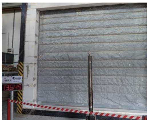
Brama mcr EBR 120 w laboratorium ogniowym w trzeciej godzinie badania (136 minuta, 45 sekunda) w nienaruszonym stanie
