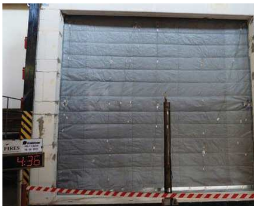
Brama mcr EBR 120 w laboratorium ogniowym w piątej minucie testów
